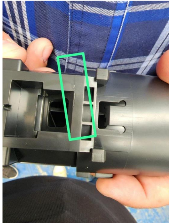
Imagen 30: Pieza golpeada y con falla al momento de su expulsión.
