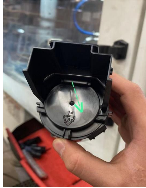
Imagen 32: Pieza golpeada por botadores de presión.
