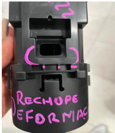
Imagen 16: pieza golpeada y con deformidad.
