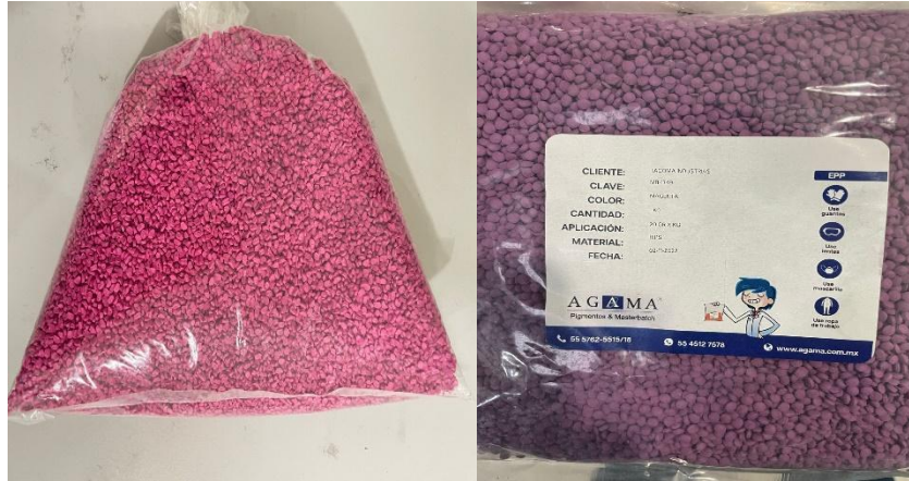
Imagen 26: Diferencia de tonos de pigmento de Masterbatch magenta
