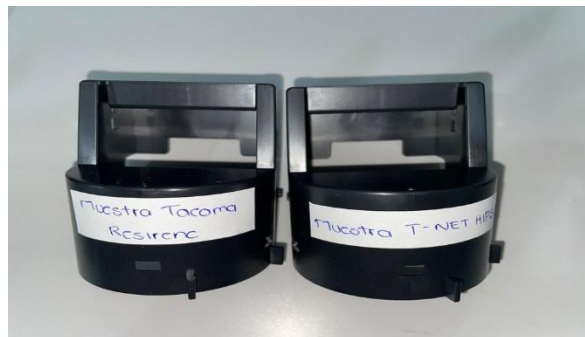
Imagen 25: Prueba de Handle negro “K” o “BK” con material HIPS PS3122.
