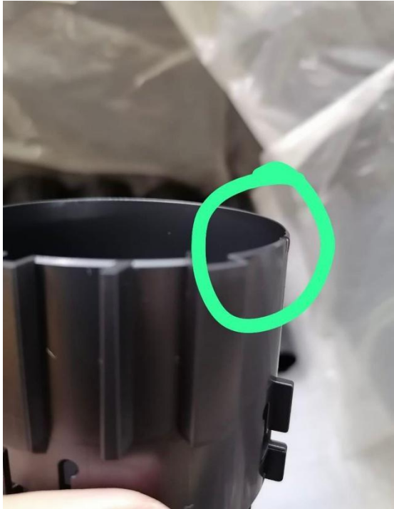
Imagen 29: Pieza golpeada con falta de material.
